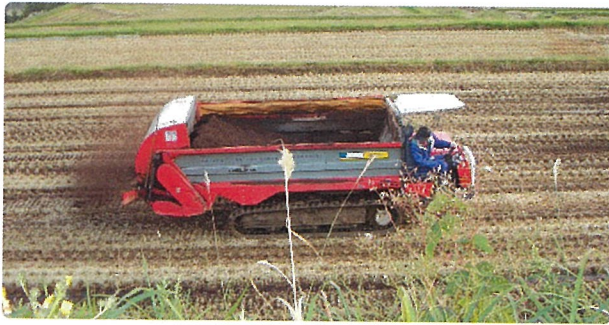
マニユアスプレッダーによる堆肥の散布(氷見)
