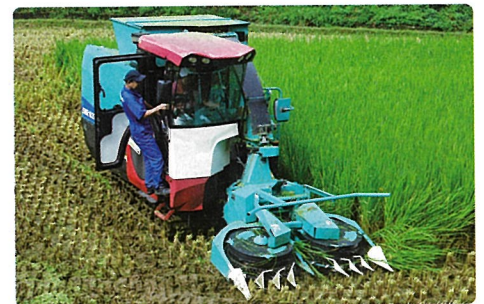
WCS調整収穫専用機による収穫
